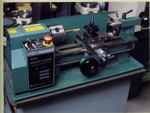
小型旋盤FL-350E。ベッド上振り180mm、クロススライド上振り100mm、芯間350mm、主軸回転100～2500rpm。小型の鉄道模型だけなら、このクラスで十分に思い通りの部品ができる。標準セットは18万円（税・送料込み）
