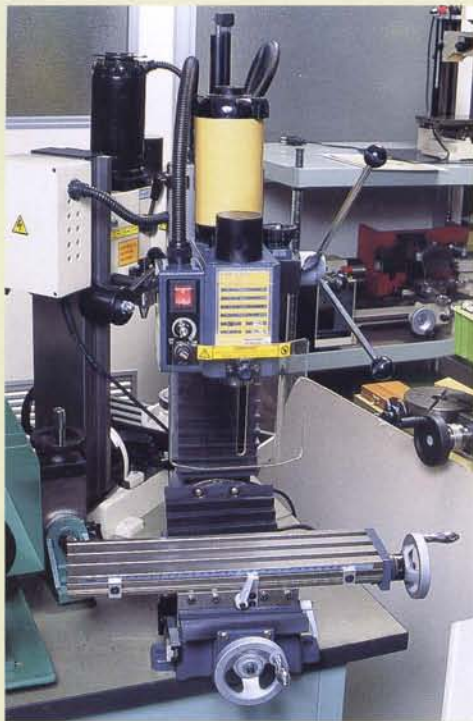
卓上フライス盤FM-100。軸端—テーブル間は250mm、フトコ口160mm、テーブル380×92mm、左右（長手）送り228mm、クロス（前後）送り88mmで角度付きの加工もできる。モーターは1/2HP。標準セットは税・送料込みで185,000円。各種のエンドミルなどの付属機器も販売している
