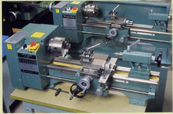
同社で最も小型な旋盤FL-260E。基本性能はFL-350Eと同じだが、芯間が100mm短い250mmの省スペース型。価格はフルセットで16万円（税・送料込み）
