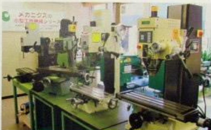
寿賀島における中型機とも見えるフライス盤。右からFM120E SUPER(軸端/テーブル間50mm)、FM15E(軸端/テーブル間375mm)、M15(軸端/テーブル間270mm)。サイズ的には同じでも、駆動方式、計測機の有無、ヘッド構造など、想像以上に違いがあるので注意しよう
