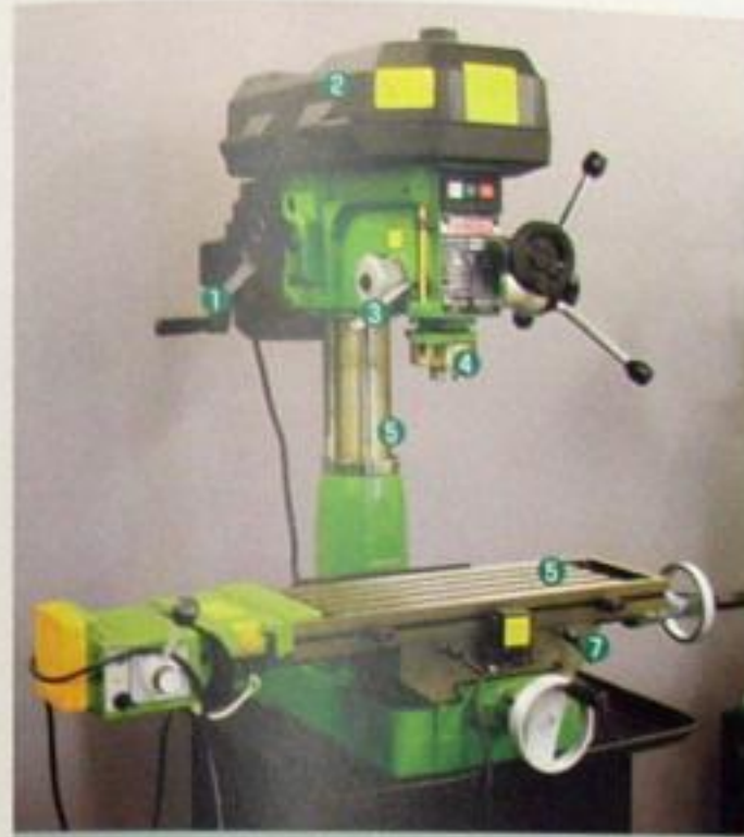
①主軸ヘッド上下ハンドル ②主軸ヘッド ③タイルストップバー ④主軸 ⑤コラム ⑥テーブル ⑦サドル
