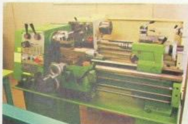
買ってこられた最大級のUSLS。心棒100mmで、最大φ100mmの物がチャックできる。重さ約280kg、幅約1.5mとビッグサイズ。モーターも三相200V1500Wが標準(100V750Wも選べる)となる
