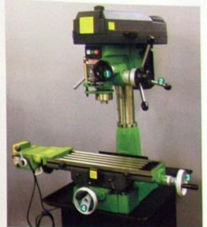
①タイル移動送りハンドル ②タイル送り出しレバー ③左右送りハンドル ④前後送りハンドル
