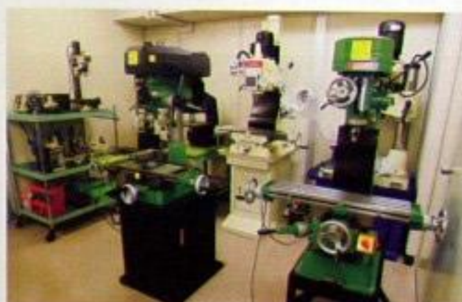
こちらの写真はフライス盤の大型タイプ代表。左の機械は先のページで紹介済みのM20A(軸端/テーブル間300mm)で、右の機械はM20E(軸端/テーブル間300mm)でヘッドが垂直型。水平面に設置するヘビードライヤー機
