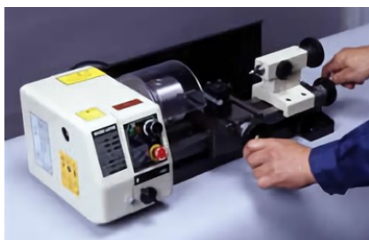
使用例(シングルツールポストにバイトを取付)
