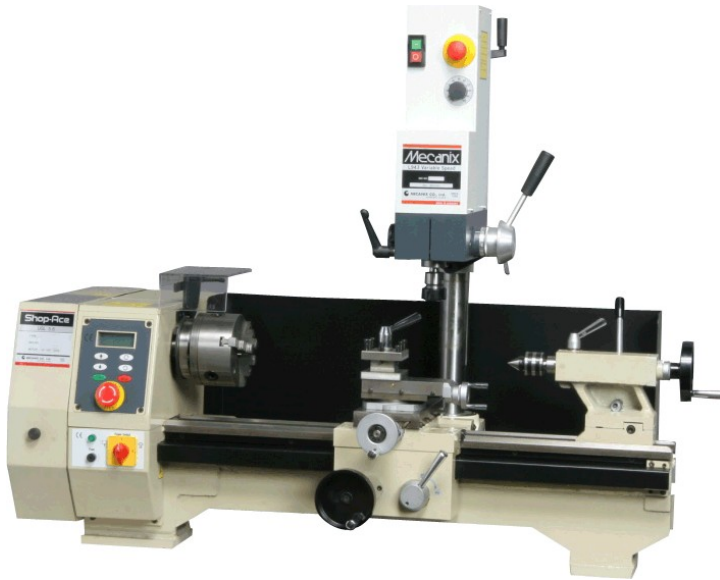
万能工作機械(USL5.6M+ミーリングアタッチメントV型)
