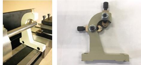
往復台に取り付け、常にバイトと共に移動し、バイトの圧力でワークがたわんで逃げるのを防ぎます。
