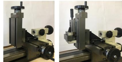
簡易的にミーリング作業を行うために用います。旋盤の主軸側にエンドミル等のフライス用切削工具を取り付ける事により、パーティカルスライド側に固定したワークの切削が可能になります。
