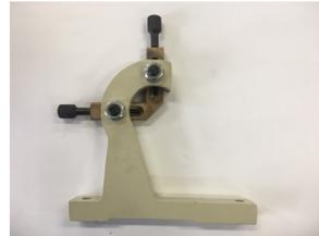
細長くシャフトのようなワークを加工する時、バイトの圧力で工作物が逃げ、工作精度が悪くなるのを防止するための装置です。
