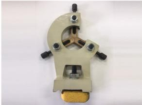
心押台のセンターで支持できない形状のワークを加工する時に使用します。
