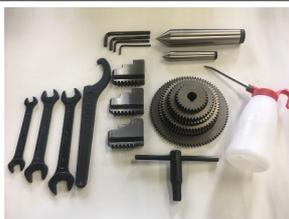
固定センタ MT2・MT4、チェンジギアセット（ねじ切用）、三爪スクロールチャック用ハンドル・逆爪（3個1組）、工具類（ロットにより多少異なる場合があります）
