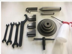
固定センター MT2・MT4、チェンジギアセット（ねじ切用）、三爪スクロールチャック用ハンドル・逆爪（3個1組）、工具類（ロットにより多少異なる場合があります）
