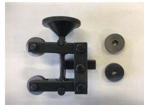
ハンドルやつまみにギザギザをつける作業に使用します。旋盤の刃物台に取り付け、工作物に押しつけてギザギザをつけます。（"気配り"調整済）
