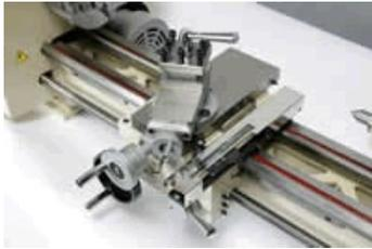
オプションでクロス（前後）方向にデジタルスケール（ミットヨ製）が取り付けられます。
